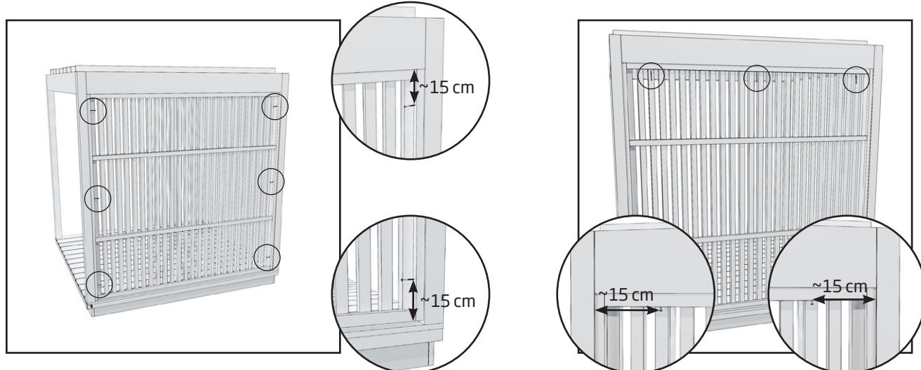
2. Montera insynsskyddet med tre (4,2 x 75 mm) skruvar på båda sidor om pergolans stolpar, skruvarna fästs på utsidan av pergolan. Ett litet mellanrum uppstår mellan insynsskyddet och pergolans däck.
