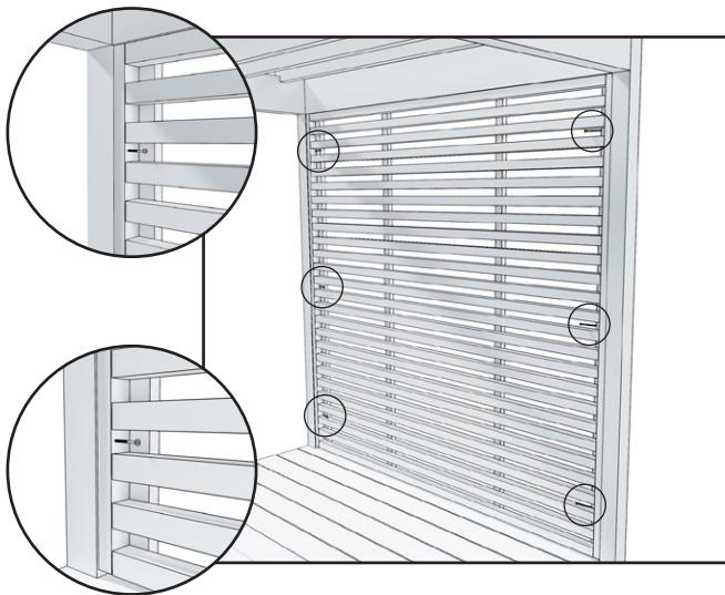
2. Kiinnitä kolmella ( $4,2 \times 75 \text{ mm}$ ) ruuvilla näkösuoja molemmilta puolilta pergolan pystytolppi, ruuvit kiinnitetään pergolan sisäpuolelta. Näkösuojan ja pergolan kannen väliin jää hieman rakoa.
