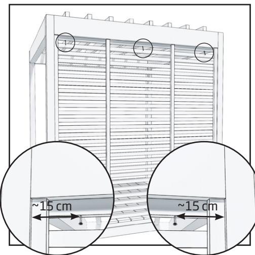
2. Kiinnitä kolmella ( $4,2 \times 75$  mm) ruuvilla näkösuoja ylhäältä pergolan yläkiertoon kiinni.
