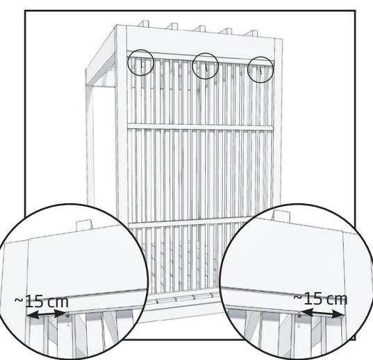
2. Fissare il paravento da giardino al telaio superiore della pergola con tre viti (4,2 x 75 mm).
