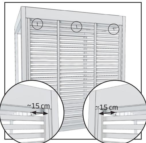
3. Kiinnitä kolmella ( $4,2 \times 75 \text{ mm}$ ) ruuvilla näkösuoja ylhäältä pergolan yläkiertoon kiinni.
