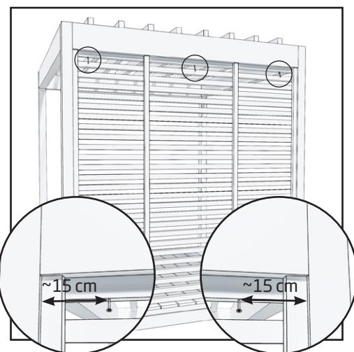
2. Fissare il paravento da giardino al telaio superiore della pergola con tre viti (4,2 x 75 mm).
