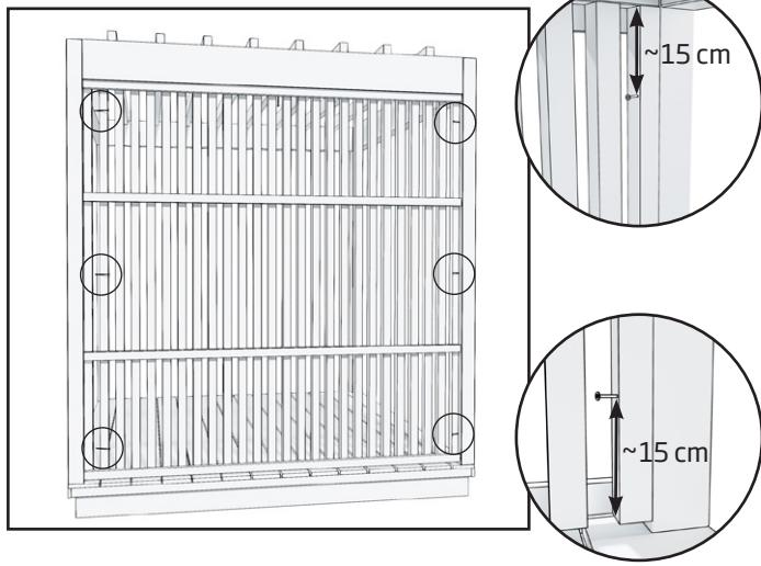
1. Befestigen Sie den Sichtschutz mit je drei Schrauben (4,2 x 75 mm) von der Außenseite der Pergola aus an beiden Seiten der vertikalen Pfosten der Pergola. Zwischen dem Sichtschutz und dem Pergola-Deck wird ein kleiner Spalt bleiben.
