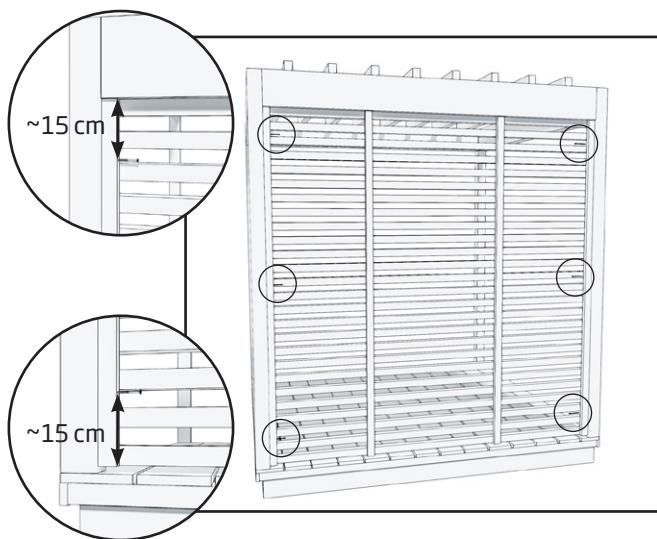
1. Befestigen Sie den Sichtschutz mit je drei Schrauben (4,2 x 75 mm) von der Außenseite der Pergola aus an beiden Seiten der vertikalen Pfosten der Pergola. Zwischen dem Sichtschutz und dem Pergola-Deck wird ein kleiner Spalt bleiben.
