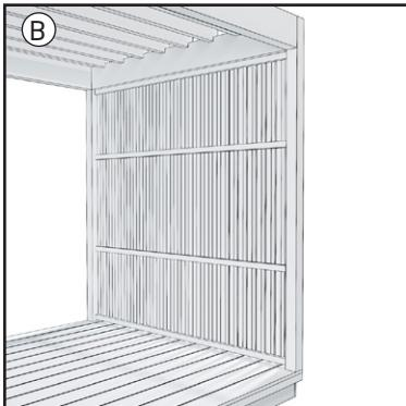
Es ist auch möglich, den Sichtschutz so zu montieren, dass die Verbindungsplatten auf seiner sichtbaren Seite liegen.
