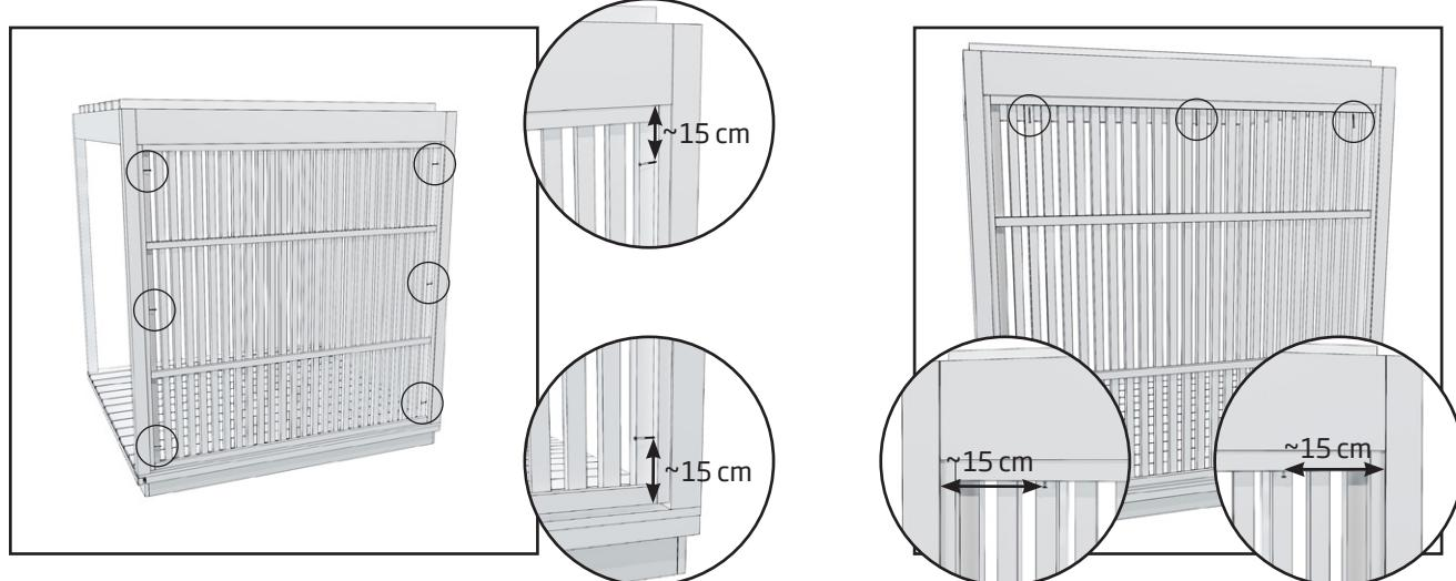
2. Befestigen Sie den Sichtschutz mit je drei Schrauben (4,2 x 75 mm) von der Außenseite der Pergola aus an beiden Seiten der vertikalen Pfosten der Pergola. Zwischen dem Sichtschutz und dem Pergola-Deck wird ein kleiner Spalt bleiben.
