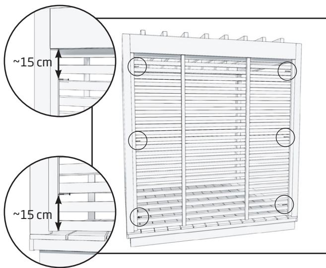
1. Maak het tuinscherm vast aan beide kanten van de verticale palen van de pergola. Gebruik daarvoor telkens drie schroeven (4,2 x 75 mm) die je er langs de buitenkant van de pergola in schroeft. Tussen het privacyscherm en de pergolavlonder ontstaat er een kleinge gleuf.
