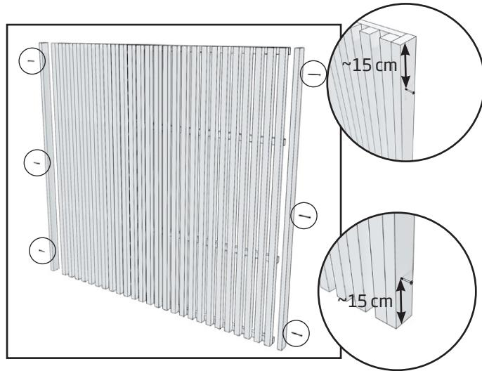
1. Attachez des pièces de remplissage aux côtés du pare-soleil à l'aide de 3 vis (4,2 x 55 mm) par pièce. Laissez les vis les plus aux bords écartées d'environ 15 cm des bords pour éviter les craquements.
