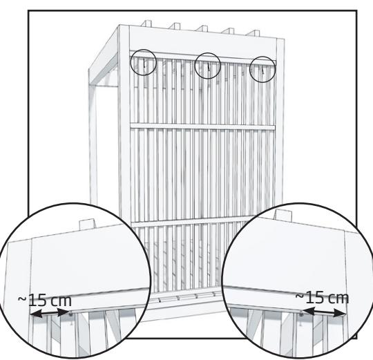
1. Befestigen Sie den Sichtschutz mit je drei Schrauben (4,2 x 75 mm) von der Außenseite der Pergola aus an beiden Seiten der vertikalen Pfosten der Pergola. Zwischen dem Sichtschutz und dem Pergola-Deck wird ein kleiner Spalt bleiben.
