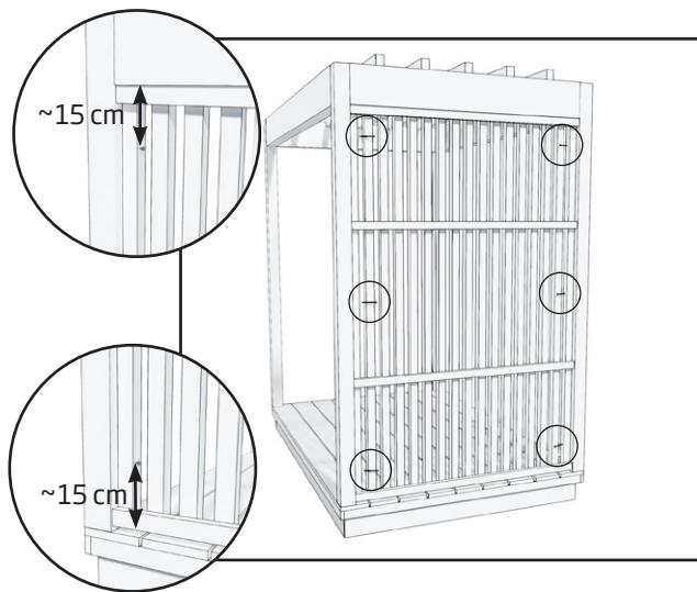
1. Maak het tuinscherm vast aan beide kanten van de verticale palen van de pergola. Gebruik daarvoor telkens drie schroeven ( $4,2 \times 75$  mm) die je er langs de buitenkant van de pergola in schroeft. Tussen het privacyscherf en de pergolavlonder ontstaat er een kleinge gleuf.
