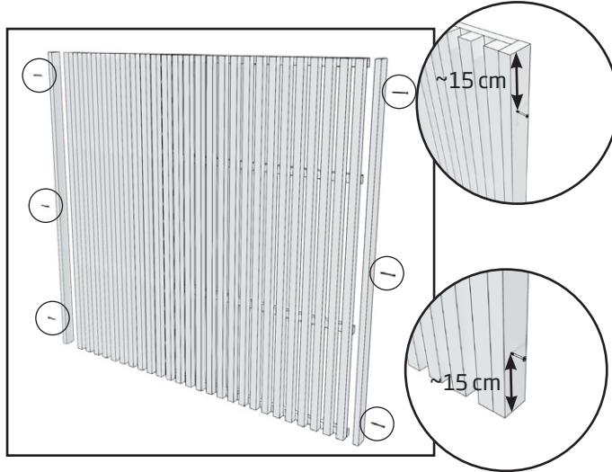
1. Befestigen Sie die Füllstücke mit 3 Schrauben (4,2 x 55 mm) pro Stück an den Seiten des Sichtschutzes. Lassen Sie die äußersten Schrauben etwa 15 cm von den Kanten entfernt, um Risse zu vermeiden.
