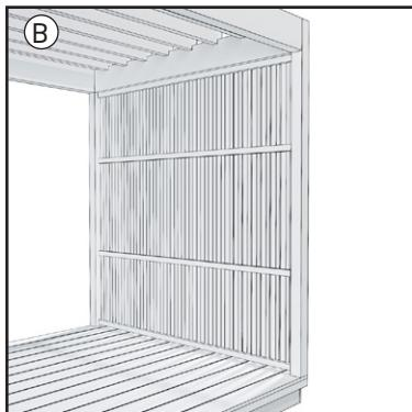
Il est également possible d'installer le pare-soleil de façon à ce que les lattes de la paroi soient visibles.
