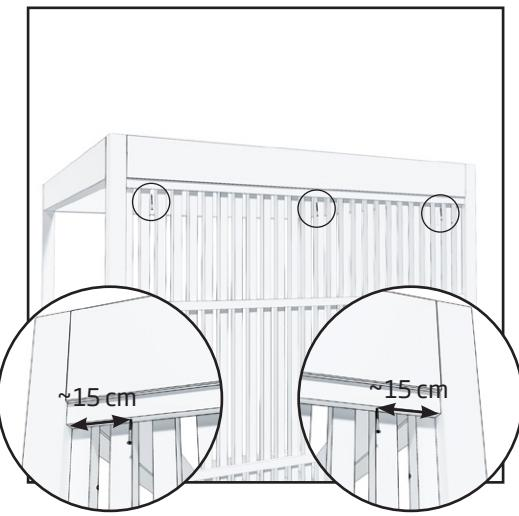
2. Befestigen Sie den Sichtschutz mit drei Schrauben (4,2 x 75 mm) am oberen Rahmen der Pergola.
