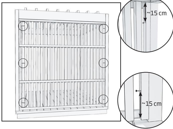
1. Maak het tuinscherm vast aan beide kanten van de verticale palen van de pergola. Gebruik daarvoor telkens drie schroeven (4,2 x 75 mm) die je er langs de buitenkant van de pergola in schroeft. Tussen het privacyscherm en de pergolavlonder ontstaat er een kleinge gleuf.
