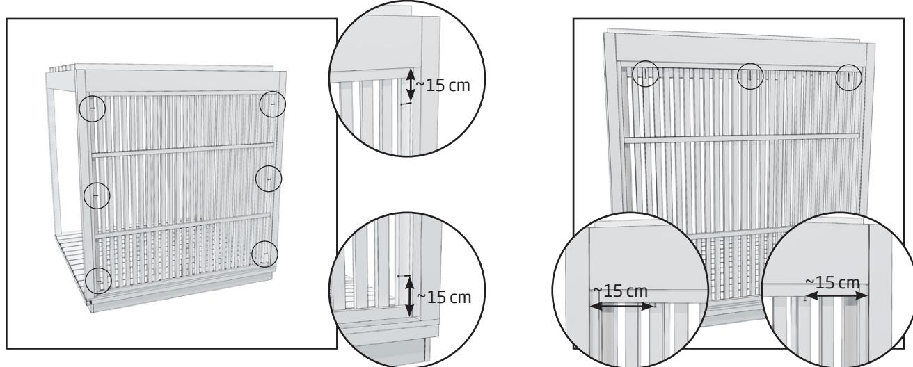
2. Kiinnitä kolmella ( $4,2 \times 75 \text{ mm}$ ) ruuvilla näkösuoja molemmilta puolilta pergolan pystytolppi, ruuvit kiinnitetään pergolan ulkopuolelta. Näkösuojan ja pergolan kannen väliin jää hieman rakoa.
