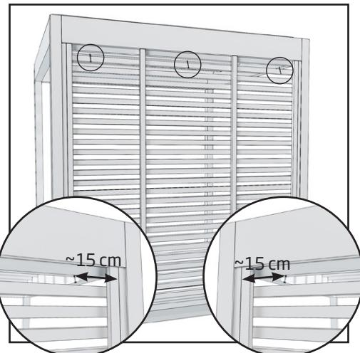
3. Montera insynsskyddet uppifrån med tre (4,2 x 75 mm) skruvar i pergolans övre varv.
