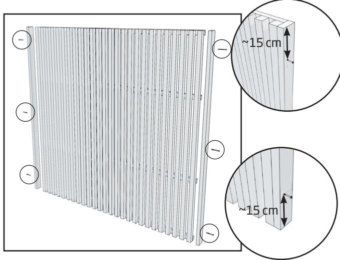
1. Bevestig de filterstukken aan de zijkanten van het privacyscherm met 3 schroeven (4,2 x 55 mm) per stuk. Laat ongeveer 15 cm afstand tussen de buitenste schroeven en de randen zodat het niet barst.
