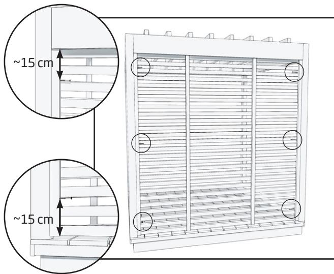
1. Kiinnitä kolmella ( $4,2 \times 75$  mm) ruuvilla näkösuoja molemmilta puolilta pergolan pystytolppi, ruuvit kiinnitetään pergolan ulkopuolelta. Näkösuojan ja pergolan kannen väliin jää hieman rakoa.
