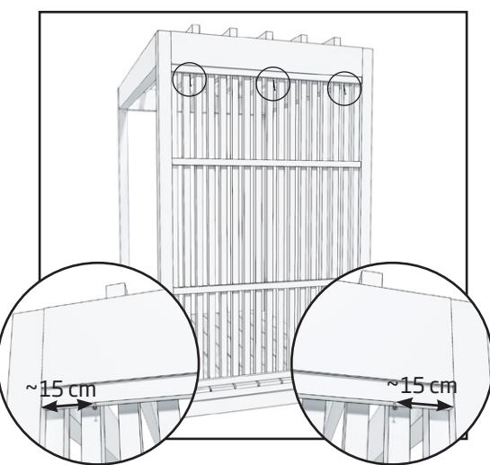
1. Kiinnitä kolmella ( $4,2 \times 75$  mm) ruuvilla näkösuoja molemmilta puolilta pergolan pystytolppi, ruuvit kiinnitetään pergolan ulkopuolelta. Näkösuojan ja pergolan kannen väliin jää hieman rakoa.
