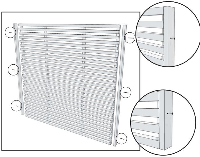
1. Bevestig de opvulstukken op de latjes aan de zijkanten van het tuinscherf met 3 schroeven (4,2 x 55 mm) per stuk. Bevestig de buitenste schroeven aan het derde latje van de boven- en onderkant.
