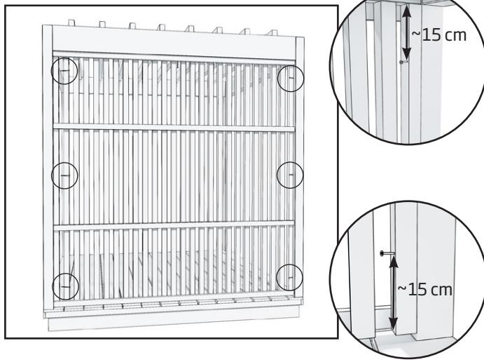
1. Kiinnitä kolmella ( $4,2 \times 75$  mm) ruuvilla näkösuoja molemmilta puolilta pergolan pystytolppi, ruuvit kiinnitetään pergolan ulkopuolelta. Näkösuojan ja pergolan kannen väliin jää hieman rakoa.
