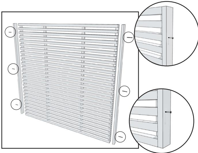
Befestigen Sie die Füllstücke mit 3 Schrauben (4,2 x 55 mm) pro Stück an den seitlichen Latten des Sichtschutzes. Befestigen Sie die äußersten Schrauben an der jeweils dritten Latte von oben und unten aus betrachtet.
