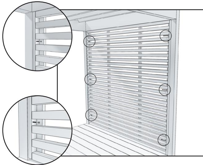
2. Montera insynsskyddet med tre (4,2 x 75 mm) skruvar på båda sidor om pergolans stolpar, skruvorna fästs på insidan av pergolan. Ett litet mellanrum uppstår mellan insynsskyddet och pergolans däck.
