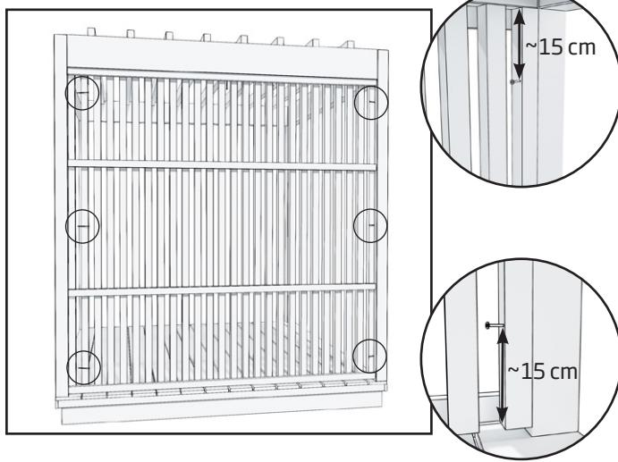
1. Montera insynsskyddet med tre (4,2 x 75 mm) skruvar på båda sidor om pergolans stolpar, skruvarna fästs på utsidan av pergolan. Ett litet mellanrum uppstår mellan insynsskyddet och pergolans däck.
