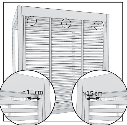
3. Fissare con 3 viti (4,2 x 75 mm) alla parte superiore.
