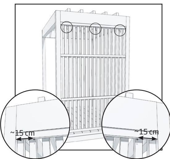
1. Montera insynsskyddet med tre (4,2 x 75 mm) skruvar på båda sidor om pergolans stolpar, skruvorna fästs på utsidan av pergolan. Ett litet mellanrum uppstår mellan insynsskyddet och pergolans däck.
