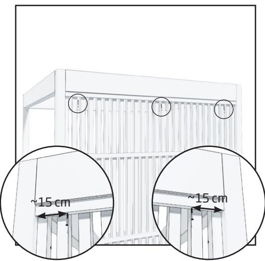
2. Montera insynsskyddet uppförifrån med tre (4,2 x 75 mm) skruvar i pergolans övre varv.
