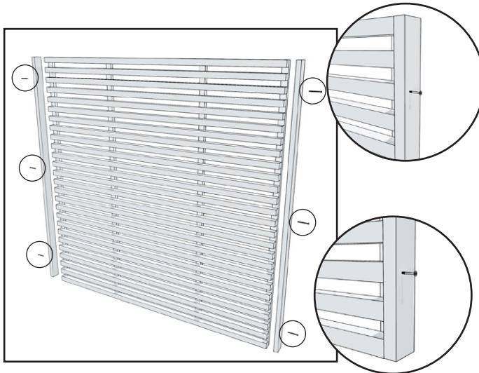
1. Kiinnitä täytepatalt näkösuojan sivuissa oleviin rimoihin kolmella ruuvilla ( $4,2 \times 55 \text{ mm}$ ) per pala. Kiinnitä reunimaiset ruuvit ylhäältä ja alhaalta laskettuna kolmanteen rimaan.
