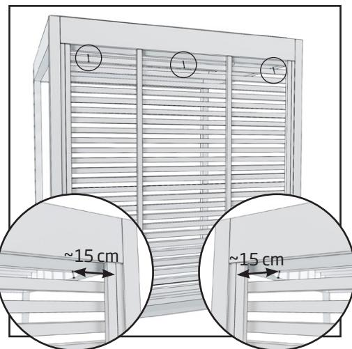
2. Befestigen Sie den Sichtschutz mit 3 Schrauben (4,2 x 75 mm) von oben an der Oberseite der Pergola.
