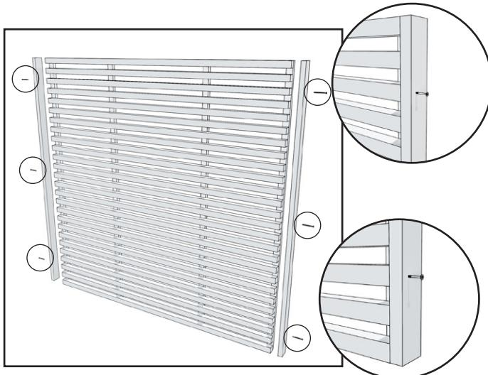
1. Montera fyllnadsbitarna i ribborna i sidorna på insynsskyddet med tre skruvar (4,2 x 55 mm) per bit. Montera de yttersta skruvarna i den tredje ribban räknat uppifrån och nedifrån.
