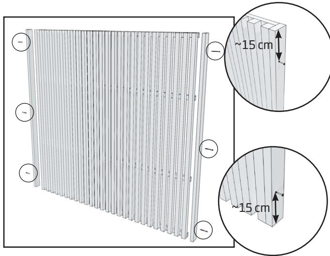
1. Montera fyllnadsbitarna i sidorna på insynsskyddet med tre skruvar (4,2 x 55 mm) per bit. Lämna de yttersta skruvarna cirka 15 cm från kanterna för att förhindra sprickor.
